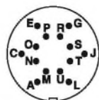
Расположение контактов разъема M16, 14-полюсн.
