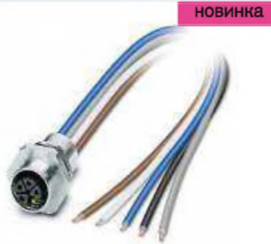
Кодировка L, сечение проводника: 2,5 мм 2 , 4-конт.+FE
